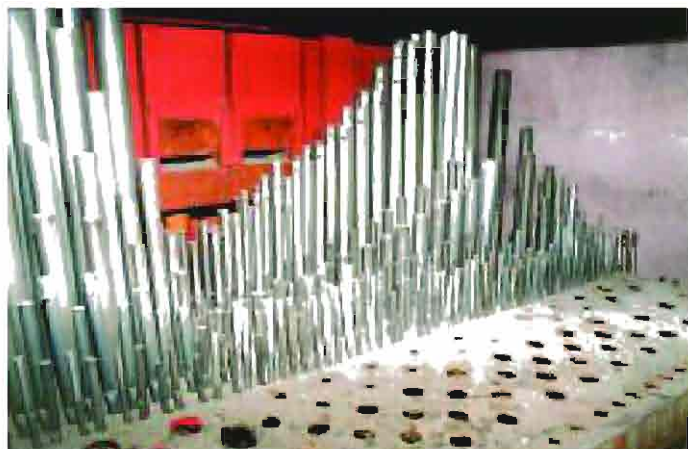
Vista generale della piramide del ripieno con dietro i registri violeggianti, si notino le piccole canne con colore diverso, quello più scuro rappresenta le canne più vecchie, mentre quello chiaro quelle più recenti. Si noti lo strato di polvere sul piano del crivello.
