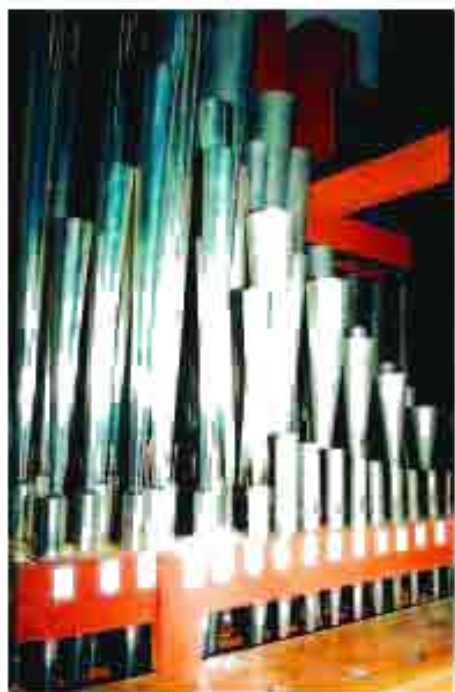
Canne nuove ad ancia del Violoncello 4' B. a sinistra, a destra canne dell'Ottavino 2' S. e dietro quello delle Trombe 8' S.
